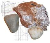
Hinsichtlich Ihrer Korngrößenverteilung als weitgestuftes Kies-Sand-Gemische mit Feinbestandteilen von  $\approx 10$  M% (Bodengruppe GU) weisen die bevorzugt im mittleren Tiefenbereich 1,0 - 2,0 m nachgewiesenen, pleistozänen Kiese g/QE geeignete Wasserdurchlässigkeiten auf.
