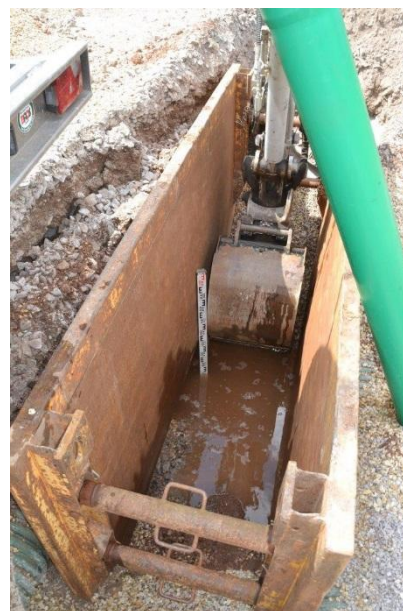
Abb. 6 - 9 Durchführung standortkonkreter Versickerungsversuch im Bereich der festgesetzten Versickerungsanlage Flst. 230/17 Quelle: Strata Ingenieure GmbH, Limbach-Oberfrohna
