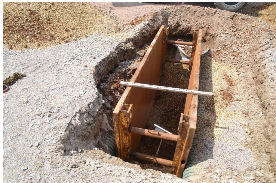
Abb. 6 - 9 Durchführung standortkonkreter Versickerungsversuch im Bereich der festgesetzten Versickerungsanlage Flst. 230/17 Quelle: Strata Ingenieure GmbH, Limbach-Oberfrohna
