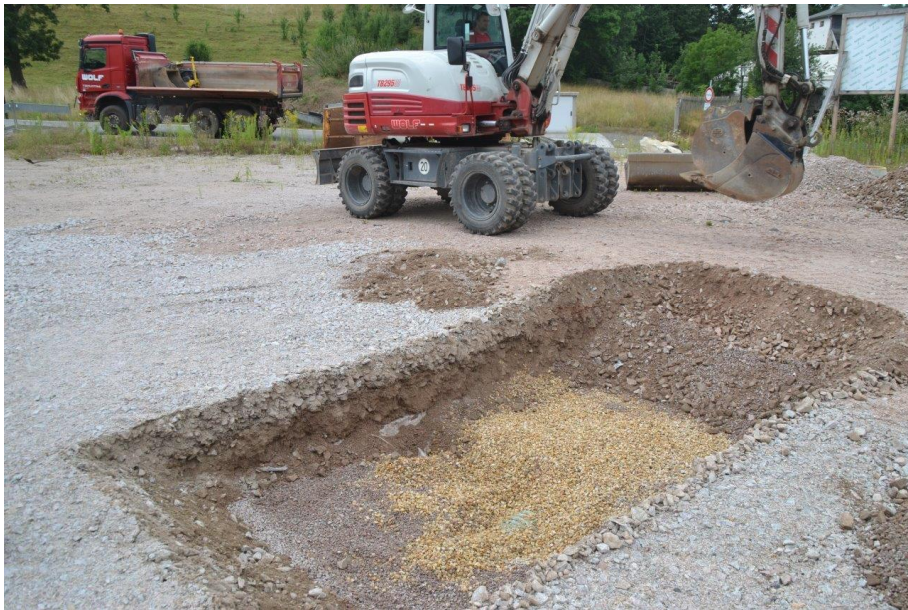
Abb. 6 - 9 Durchführung standortkonkreter Versickerungsversuch im Bereich der festgesetzten Versickerungsanlage Flst. 230/17 Quelle: Strata Ingenieure GmbH, Limbach-Oberfrohna
